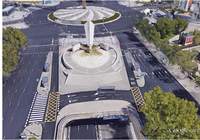
Rotterdam, a repülőtér mellett, Hollandia (szintbeni, jelzőlámpás irányítású turbó körforgalom, 5 forgalmi sávós belépőkkel)
