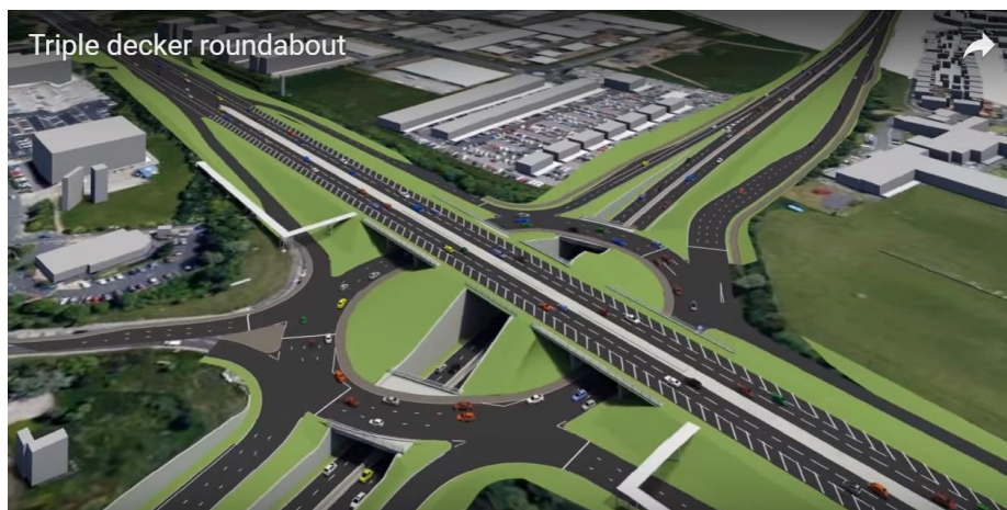
3-szintes angol körforgalom (terepszinten a körgyűrű, alagútban az egyik autópálya, felüljárón a másik autópálya, a gyűrű 3-sávós, a ki- és belépők 3-4 sávósak) [3]
