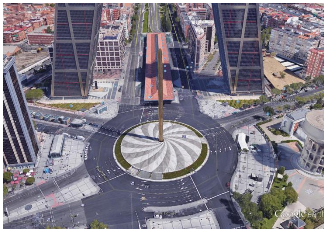
6-sávós, koncentrikus festésű gyűrű, jelzőlámpás irányítással. Alatta 2*3 sávós út megy! A szintbeni körgyűrűbe 5 forgalmi sáv lép be és ki.
