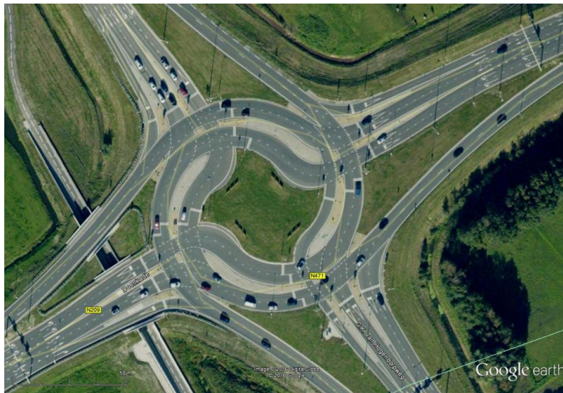
3-szintes angol körforgalom (terepszinten a körgyűrű, alagútban az egyik autópálya, felüljárón a másik autópálya, a gyűrű 3-sávós, a ki- és belépők 3-4 sávósak) [3]
