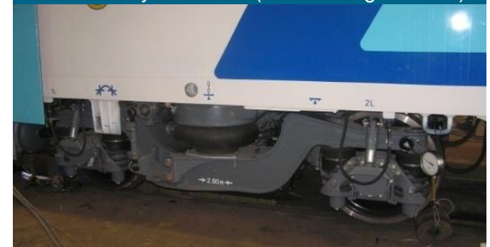
4 db SF400 forgóváz a 200 km/h sebességű IC+ személykocsikhoz (+40 db megrendelve)
