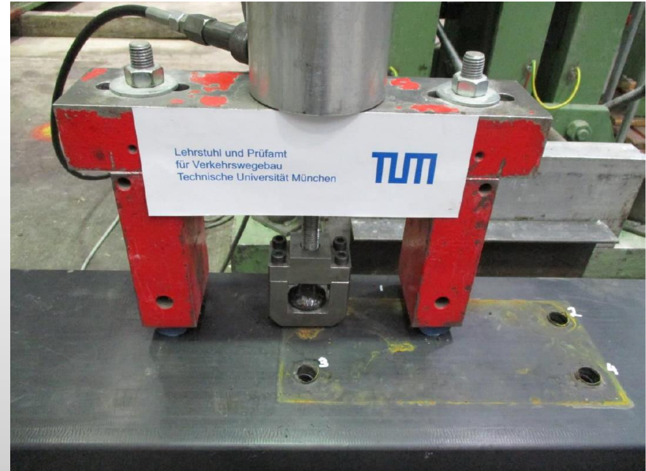
Vertikális terhelési vizsgálat a DIN EN 13481-2:2012 „A melléklete” alapján
