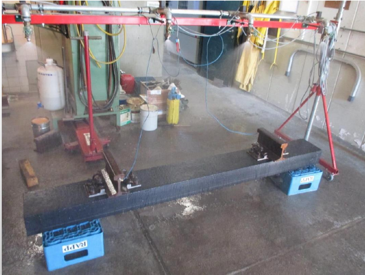
Elektromos ellenállás mérés a DIN EN 13146-5:2012 alapján
