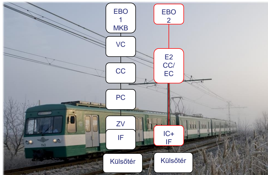
Ábra: ELEKTRA 1 → 2 átépítés – IF cserével
