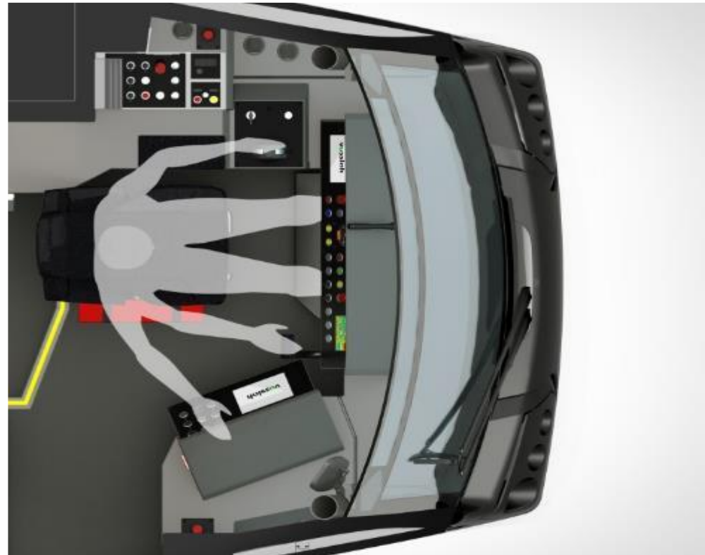
6. ábra: a vezérlő elemek elhelyezése karnyújtási távolságban
