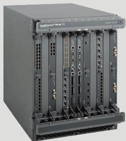
7750 SR 12 Kártyánként 50 Gb/s összességében 1 Tb/s kapacitású
