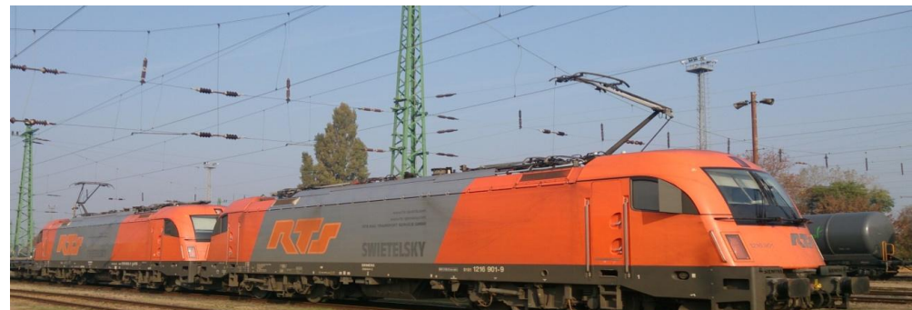
ES64U4 villamos mozdonyok Siemens Trainguard 200 ETCS berendezésekkel
