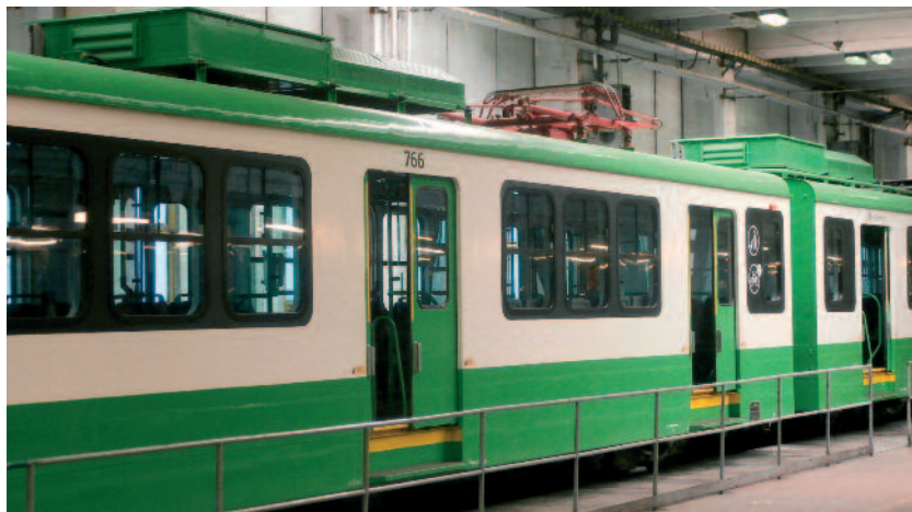
A pótkocsi légkezelő tetőegysége, a klímakompresszor egység az alvázon.
