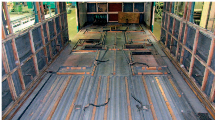
A kocsiszekrény kibontva a lemezelésig. A takarítás utáni, gyárilag kialakított korrózióvédő és dübörgéscsökkentő bevonatrendszer látható. Bevonatrendszeri javítást néhány helyen, elsősorban a tetőszerkezetenél kellett elvégezni.
